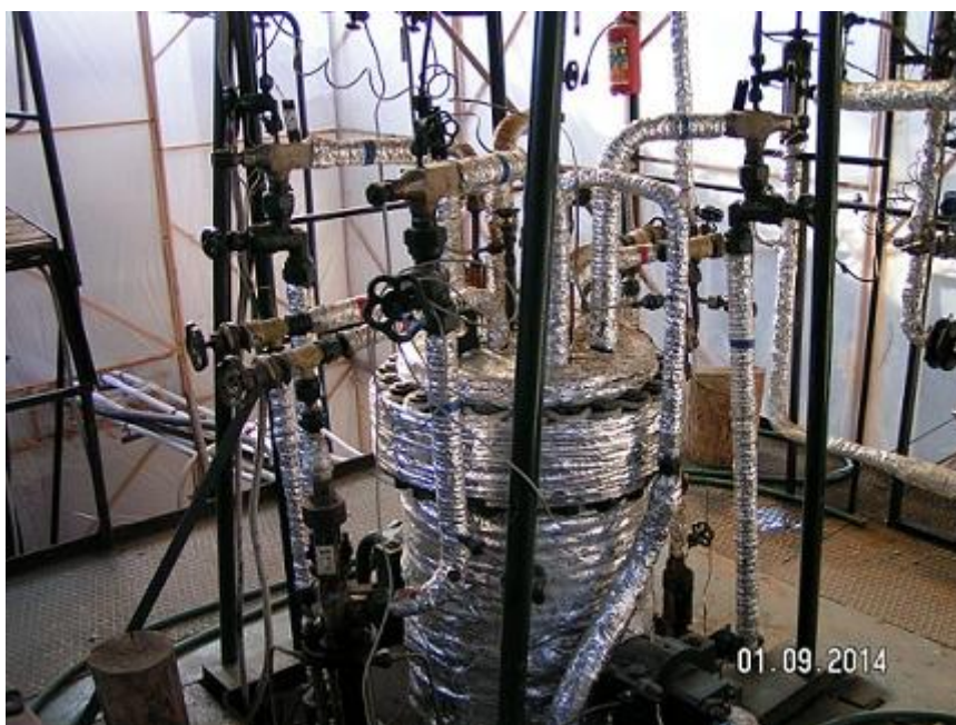
Испытательный стенд «Бета-К» на Приморской учебно-научной базе СПбГМТУ. Паропроизводящий агрегат.
